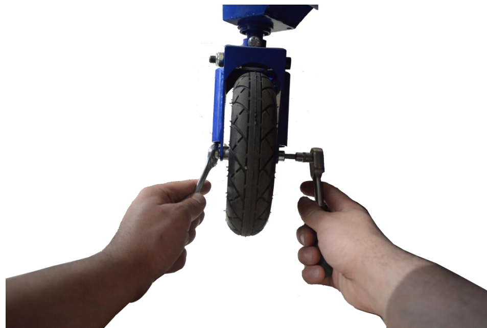
Рис. 11.2. Подтягивание оси ведомого колеса
