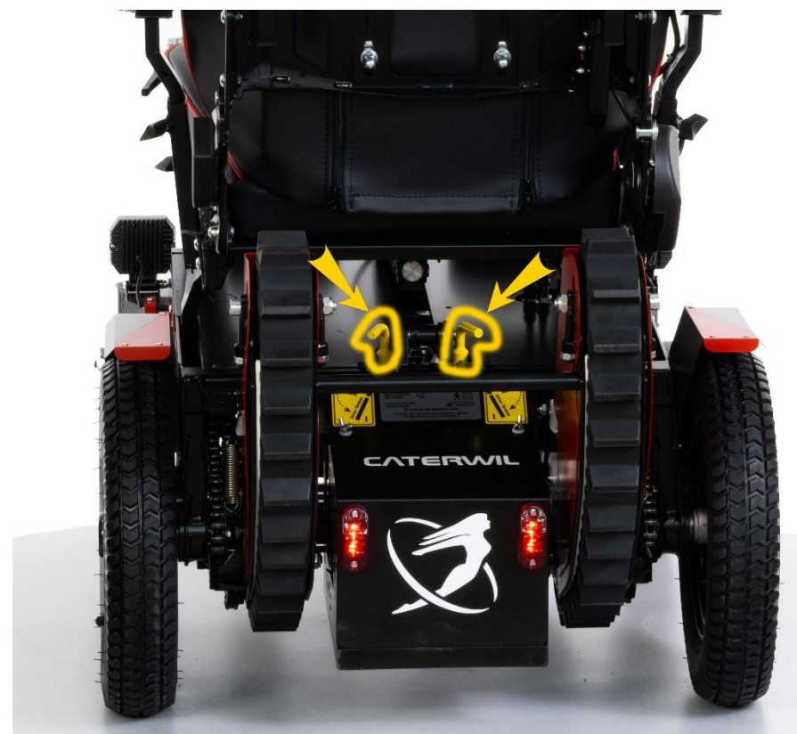
Рис.7.13. Рычаги перевода коляски в режим холостого хода
