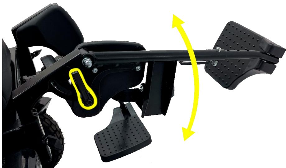
Рис.6.8. Регулировка угла голени
