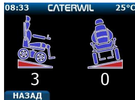
Рис. 7.7. Экран индикации угла крена и тангажа Изделия
