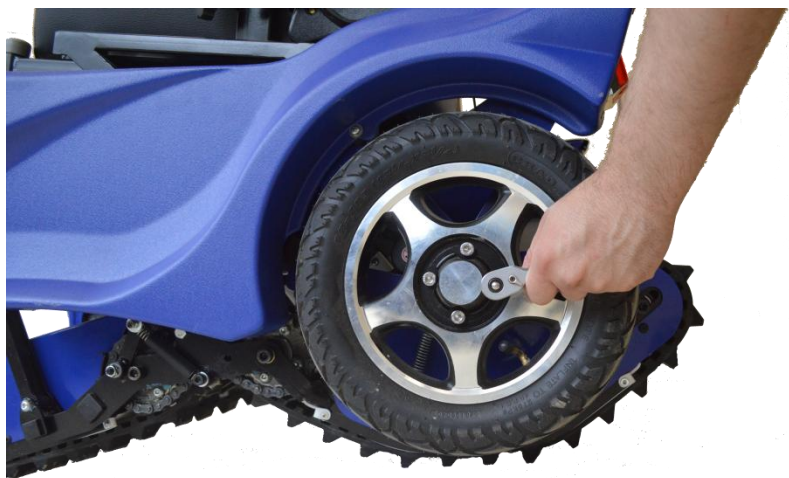
Рис. 11.1. Подтягивание винтов крепления ведущих колес
