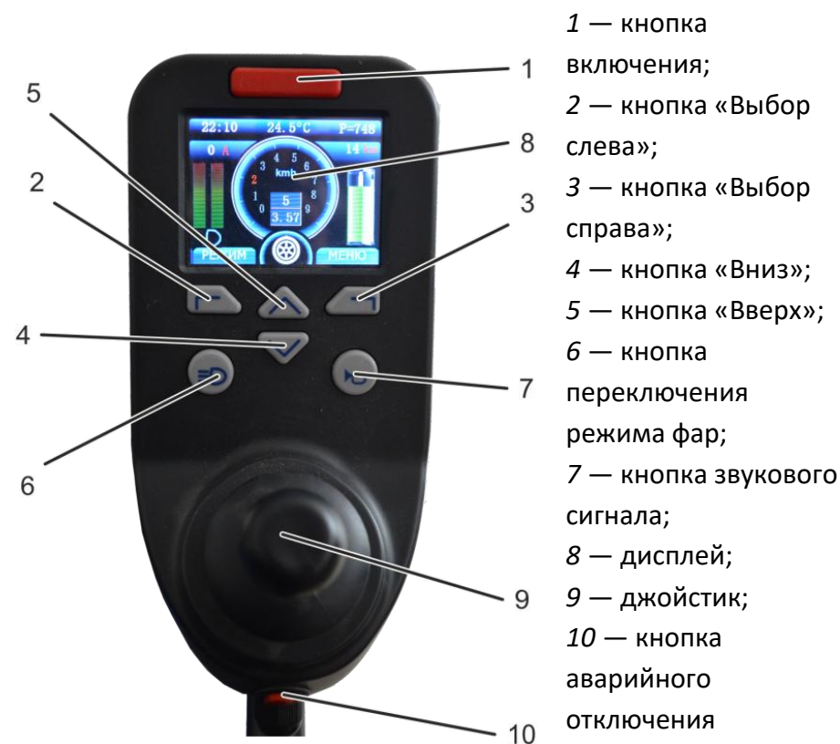
Рис. 7.2. Пульт управления с LCD-дисплеем:
