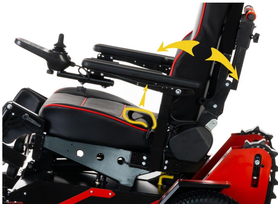
Рис.6.1. Отклонение спинки коляски
