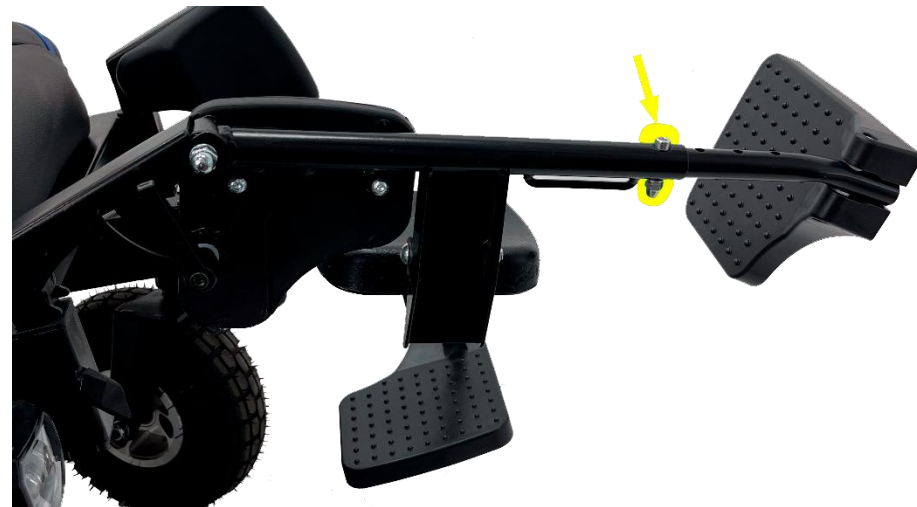
Рис.6.7. Регулировка длины подножки
