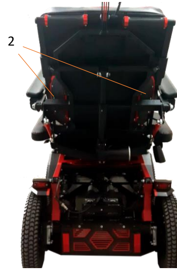
Рис. 1.2 Расположение толкателей крыла
