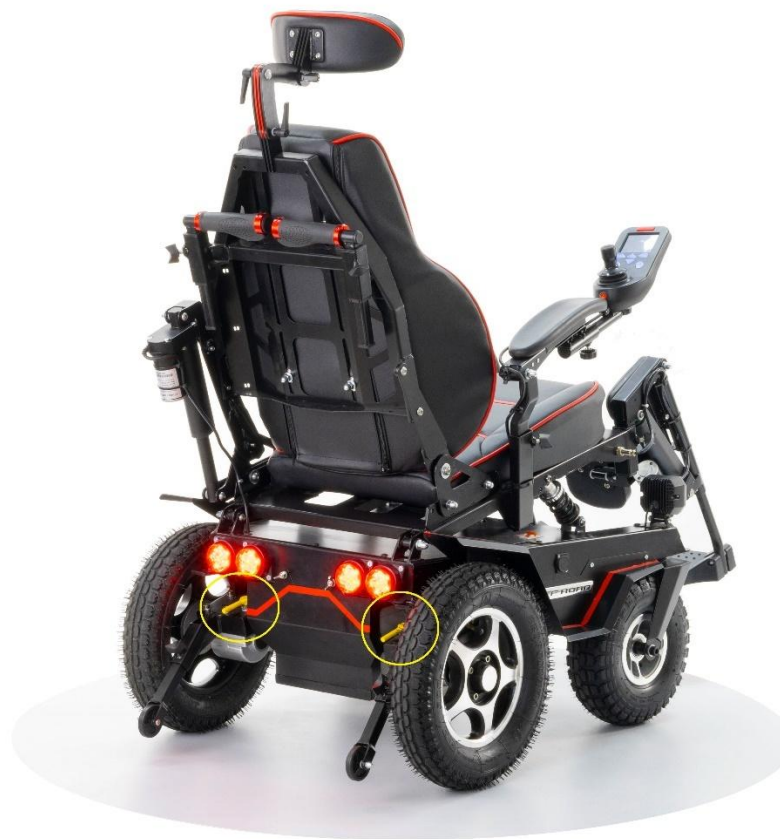
Рис. 7.14. Рычаги перевода коляски в режим холостого хода для Ultra 3, Ultra 4 и Ultra 5
