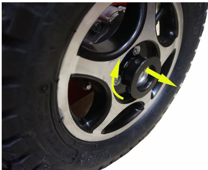
Рис 7.15. – Отключение приводов колес Ultra 4WD
