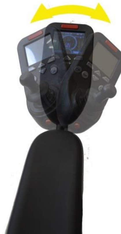
Рис. 6.5.1. Регулировка положения пульта
