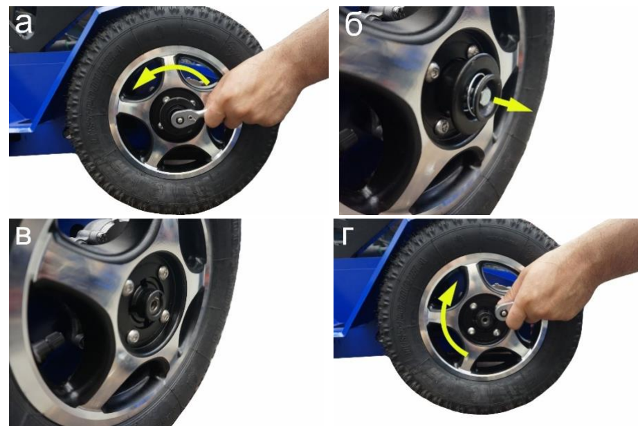
Рис. 11.1. Проверка крепления колес
