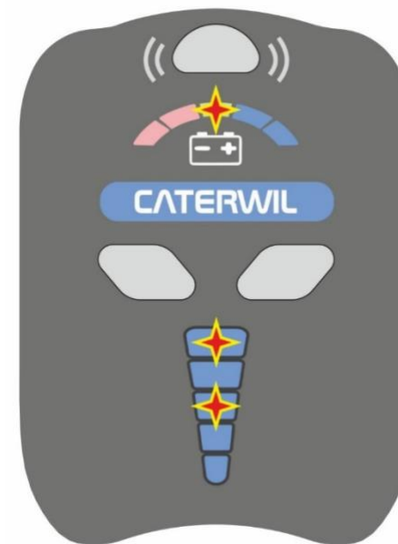
Рис. 10. Пример индикации ошибки на стандартном пульте управления
