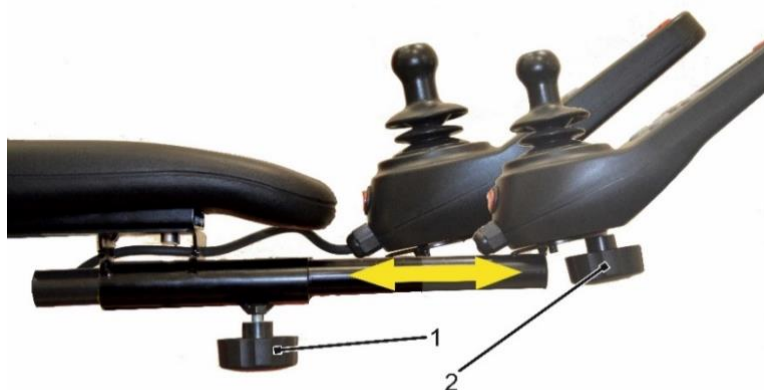
Рис. 6.5. Регулировка длины вылета пульта
