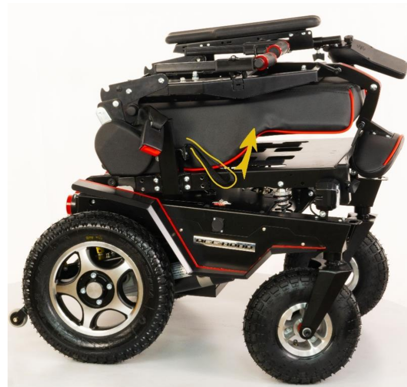
Рис. 5.1. Перевод спинки в транспортировочное положение
