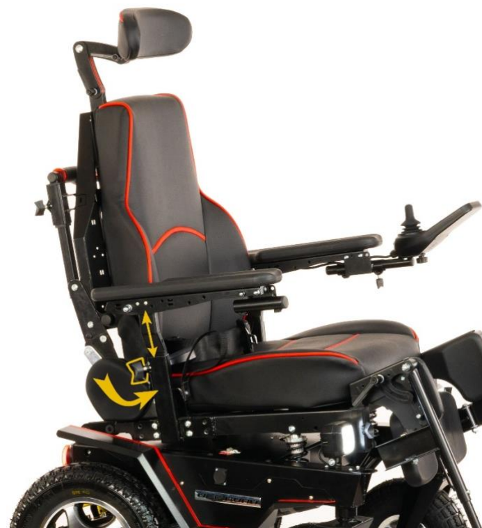
Рис. 6.3. Регулировка высоты подлокотника
