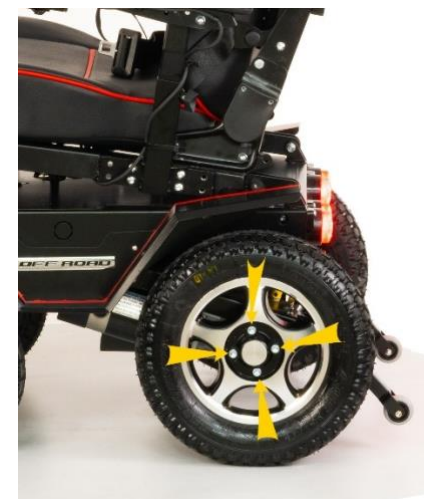
Рис. 11.2 Проверка крепления колес
