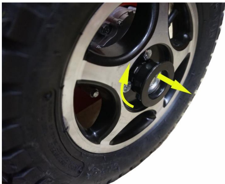
Рис 7.15. – Отключение приводов колес Ultra 4WD
