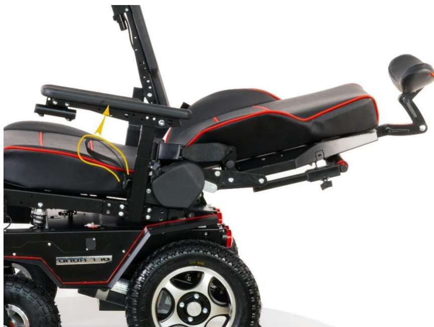
Рис. 6.2. Отклонение спинки коляски
