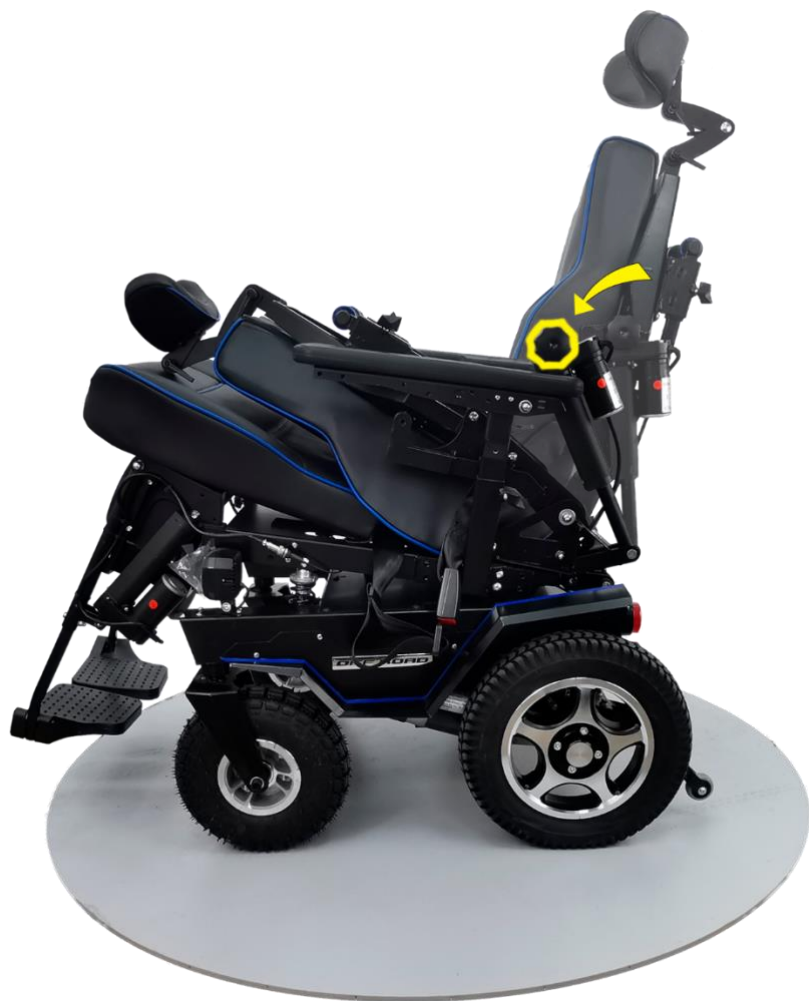
Рис. 5.2. Перевод электроступки в транспортировочное положение
