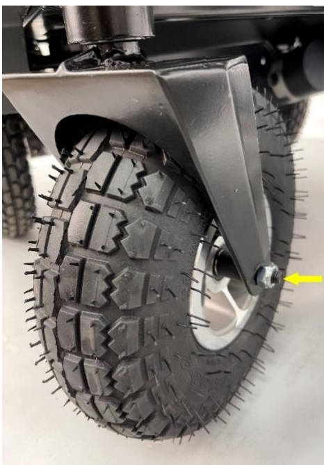
Рис. 11.2. Подтягивание оси ведомого колеса
